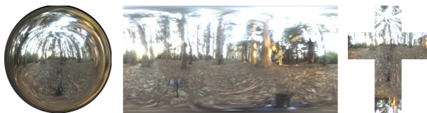
Obrázek 6: Ukázka různých způsobů mapování 3D směrem do 2D souřadnic mapy prostředí. Vlevo kruhová mapa, jejíž střed odpovídá směru přímo vpřed, obvod odpovídá směru přímo vzad a vodorovná linie procházející středem lineárně mapuje azimut na pixely. Uprostřed rozložení koule do roviny (shora dolů polární úhel, vodorovně azimut). Podobně jako kouli lze i krychli chápat jako množinu směrů z jejího středu, rozložením jejího pláště do roviny vznikne mapa vpravo. (Autor: Paul Debevec)
